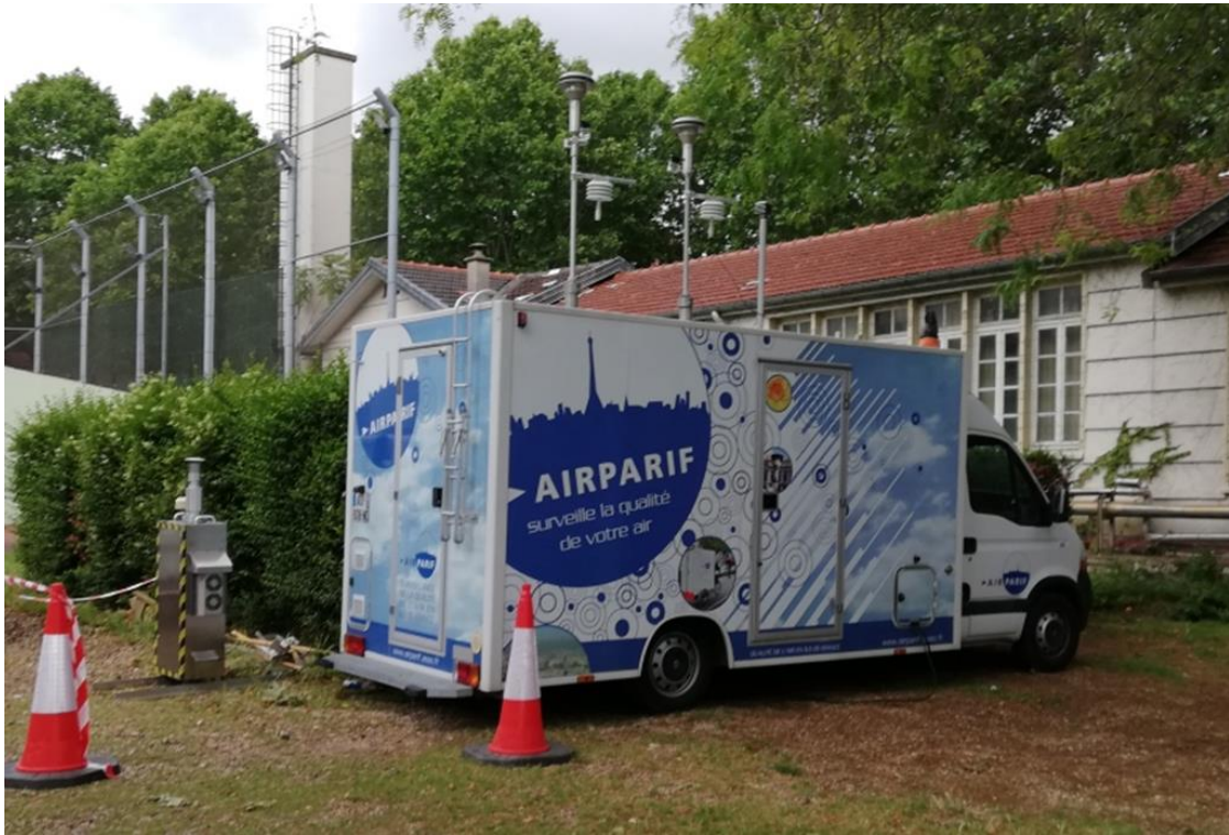
Figure 23 : Laboratoire mobile accueillant les analyseurs permettant les mesures horaires de la qualité de l'air de manière automatique
