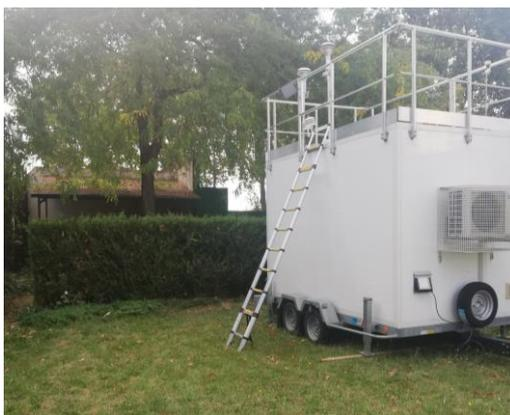
Figure 18 : Laboratoire mobile accueillant les analyseurs permettant les mesures horaires de la qualité de l'air de manière automatique
