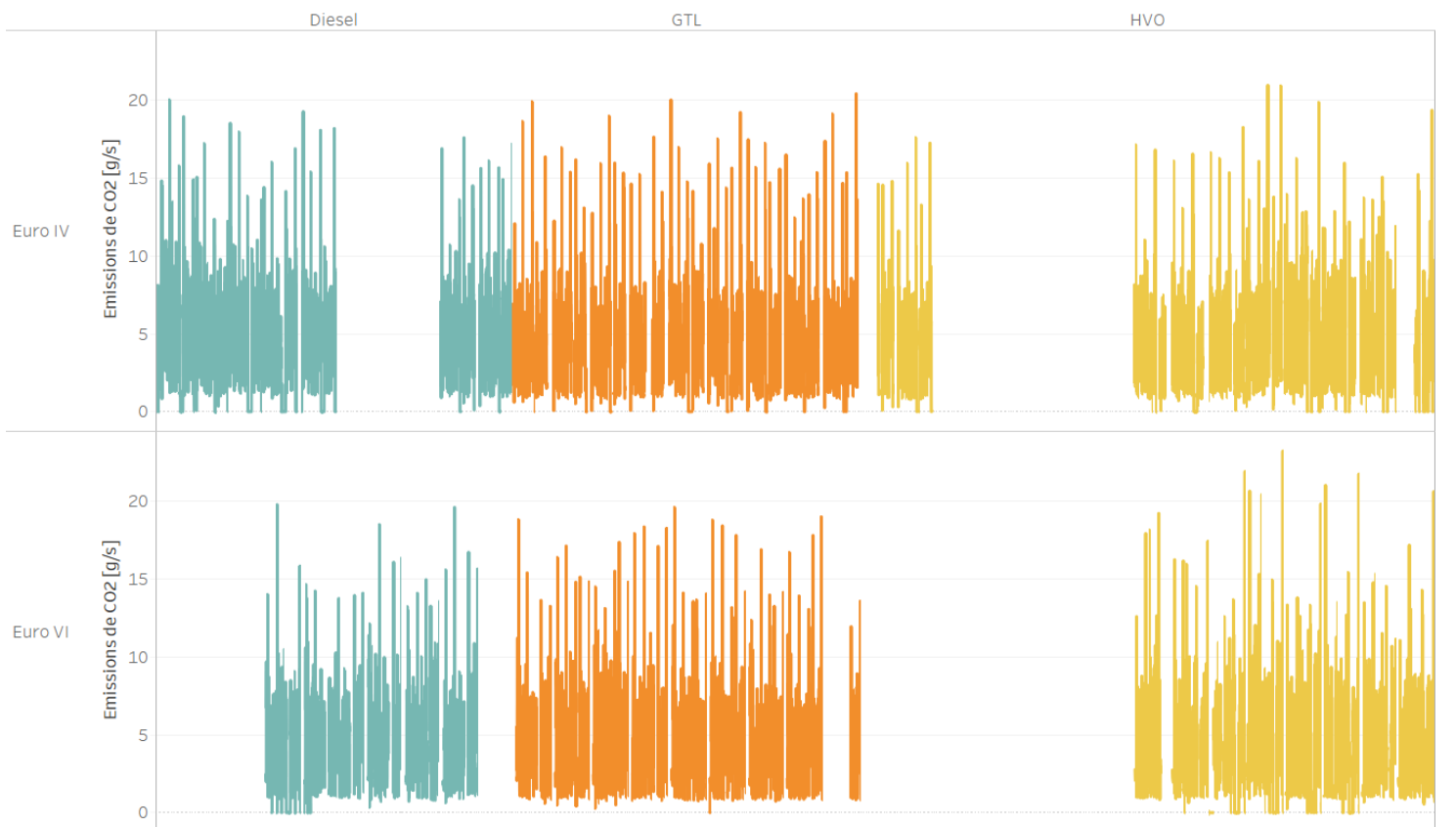
Figure 9 : Séries temporelles des émissions instantanées de CO 2 , pour le bus Euro IV et le bus Euro VI, durant les campagnes diesel, GTL et HVO. Données seconde moyennées à la minute.
