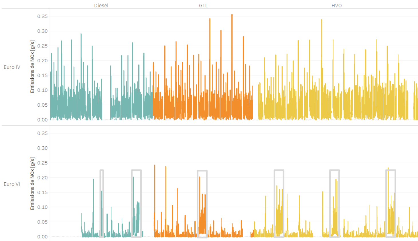
Figure 6 : Séries temporelles des émissions instantanées de NO x , pour le bus Euro IV et le bus Euro VI, durant les campagnes diesel, GTL et HVO. Données seconde moyennées à la minute. Dysfonctionnements du système de dépollution des NO x encadrés en gris (non compris dans l'analyse des émissions moyennes).
