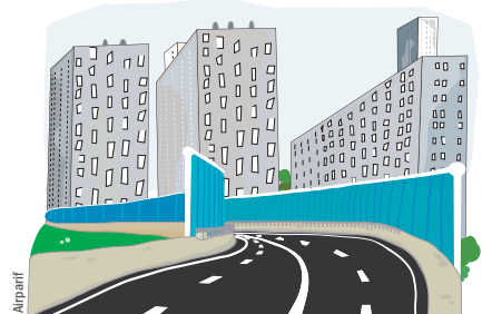
Les murs anti-bruits font écran par rapport à l'axe et ont un effet protecteur local
