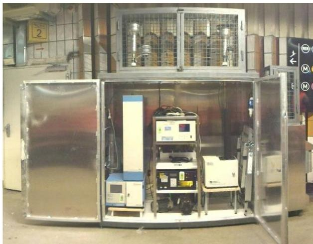
Les concentrations en particules (PM<sub>10</sub>)<sup>11</sup> et particules fines (PM<sub>2.5</sub>) ont été mesurées par analyseurs automatiques, ainsi que les NO<sub>x</sub><sup>12</sup> sur le site d'Avenue Foch.
