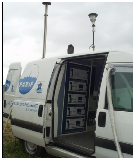
Figure A 1 : Exemple d'un laboratoire mobile accueillant des analyseurs permettant les mesures horaires de la qualité de l'air de manière automatique
