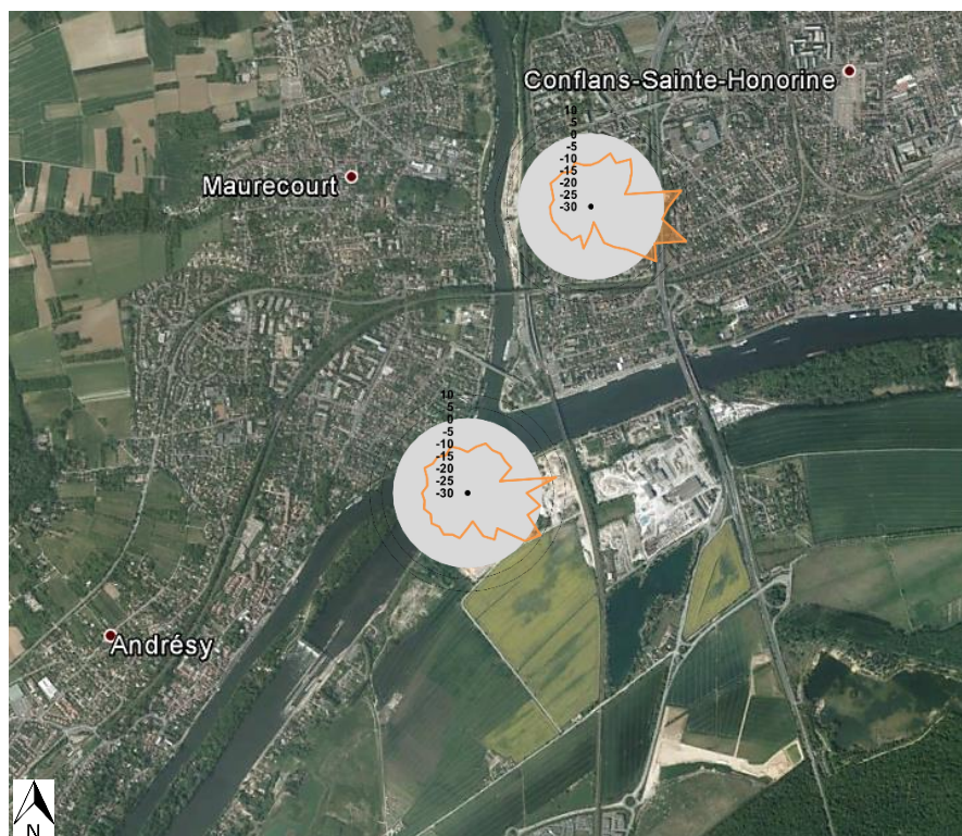
Figure 24 : Roses d'impact pour le NO 2 , avec pour référence Paris Centre (résolution horaire, en µg/m 3 )
