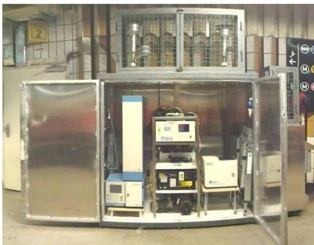
Les concentrations en particules (PM<sub>10</sub>)<sup>6</sup> et particules fines (PM<sub>2,5</sub>) ont été mesurées par analyseurs automatiques, ainsi que les NO<sub>x</sub> sur le site de Saint-Michel-Notre-Dame.
