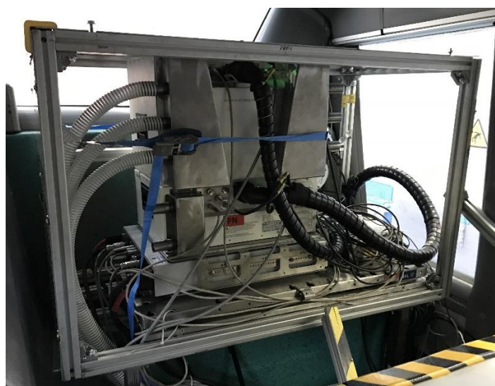
Figure 5 : Appareils de mesure : GAS PEMS au-dessus du PN PEMS
