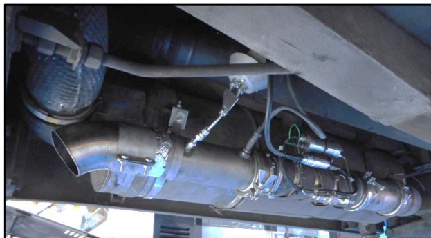
Figure 6 : Illustration de la ligne d'échappement spécifique et de la ligne de prélèvement.
