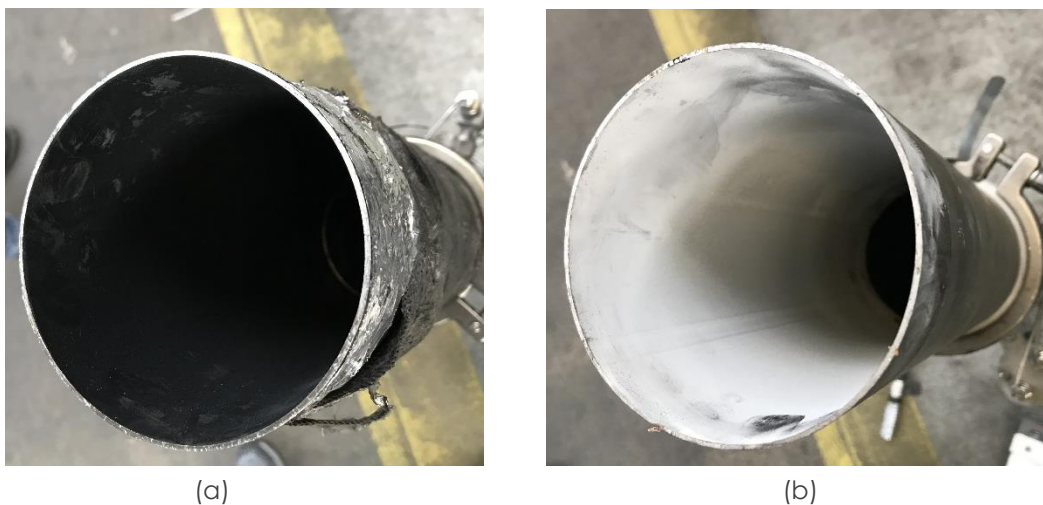
Figure 62 : Ligne d'échappement en fin de campagne pour un bus sans dysfonctionnement (a) et avec un dysfonctionnement (b)
