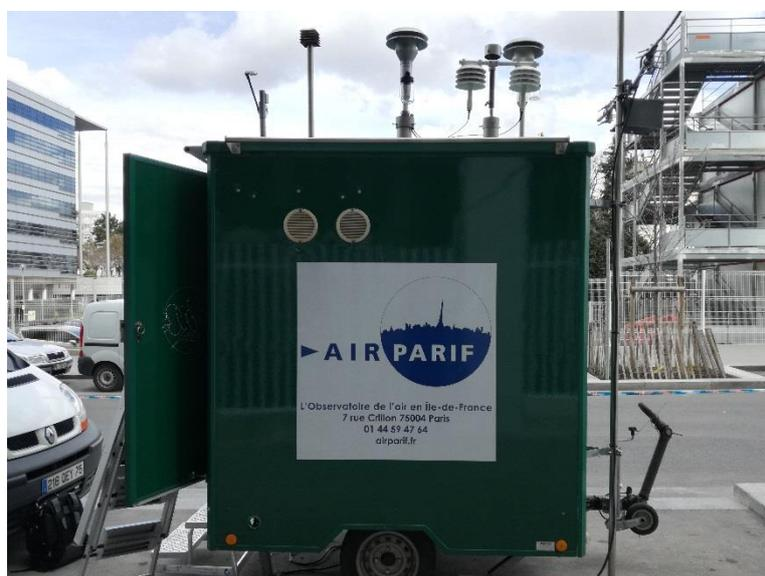
Figure A 1 : Exemple d'un laboratoire mobile accueillant des analyseurs permettant les mesures horaires de la qualité de l'air de manière automatique
