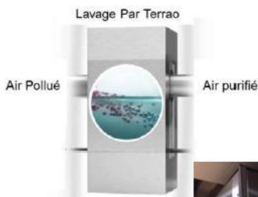
Figure 8– Schéma de principe de fonctionnement du système de dépollution TERRAO+, développé par STARKLAB.
