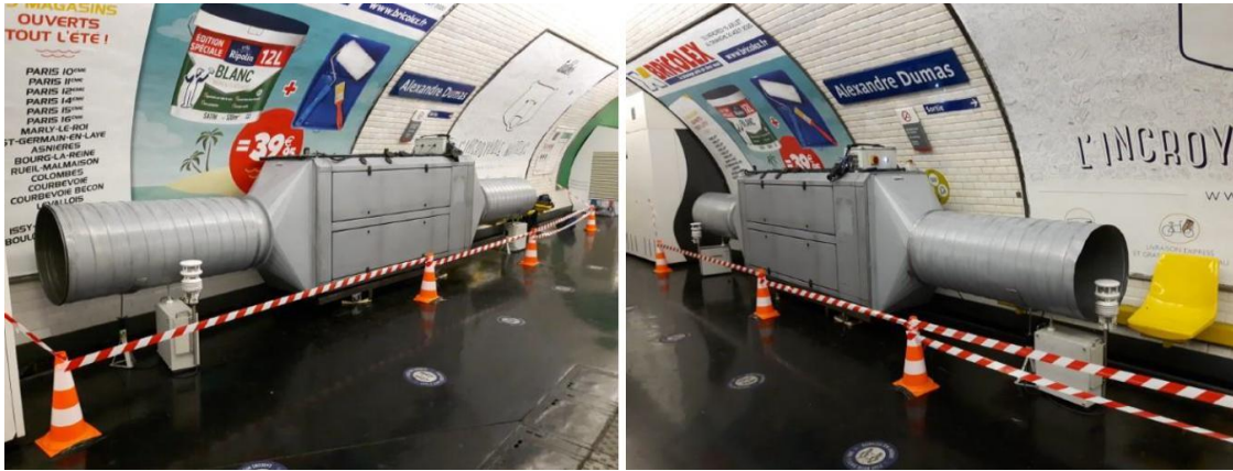
Figure 7 – Système mis en place le 16/06/2020 pour réaliser des mesures en amont/aval d'un module de dépollution par ENS, dans le cadre de l'expérimentation SUEZ à la station de métro RATP Alexandre DUMAS, ligné 2.
