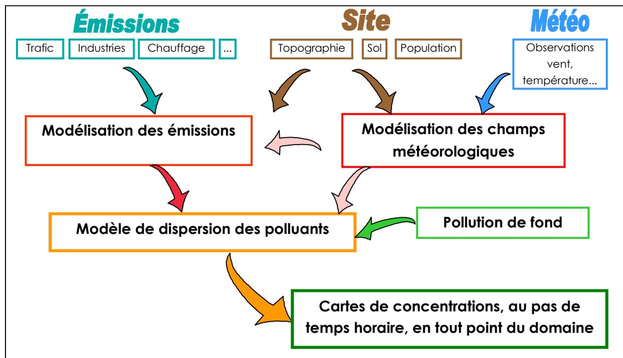
Figure 4 : Principe général de la chaîne de modélisation
