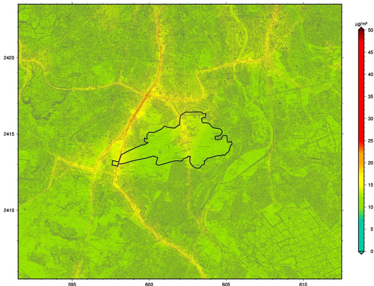
Figure 5 : cartographie du niveau moyen de particules  $\text{PM}_{2.5}$  (en  $\mu\text{g}/\text{m}^3$ ) évalué pour l'année 2017 aux abords de la plateforme aéroportuaire de Paris-Orly
