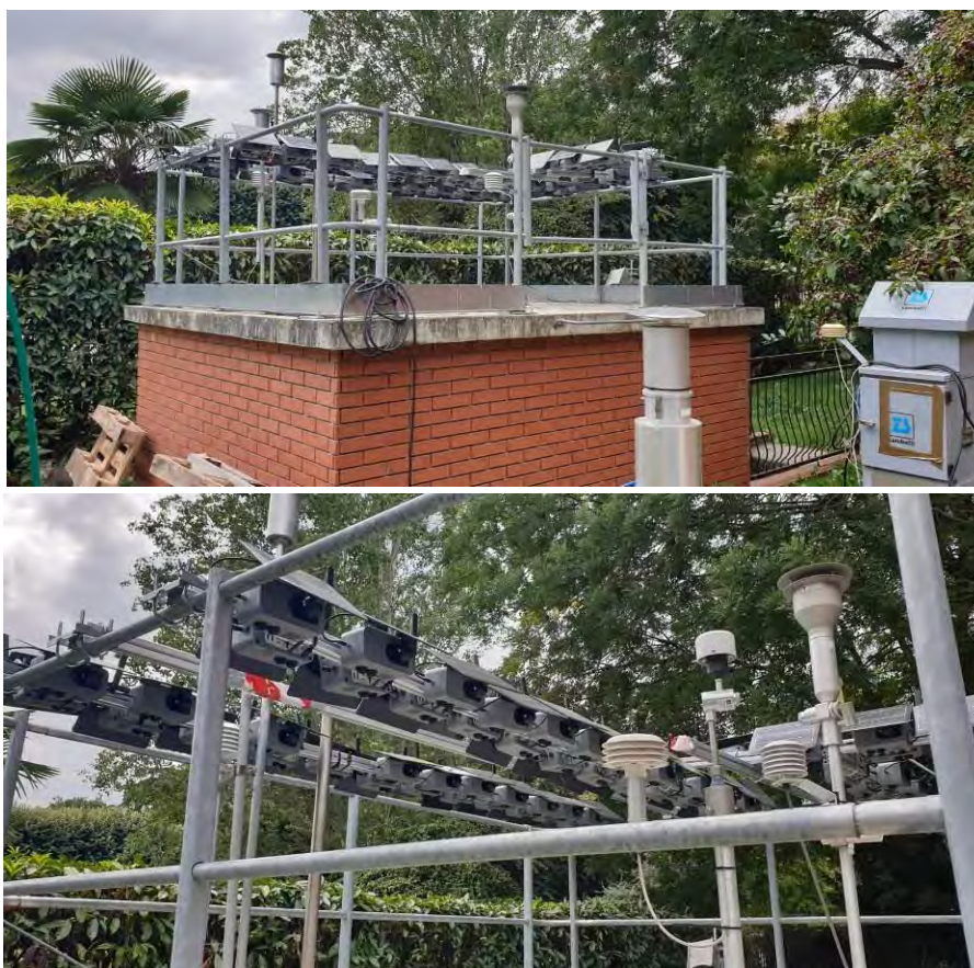
Figure 7 : Photos de la station de référence Paris 13 ème avec 50 micro-capteurs installés à côté pour leur recettage
